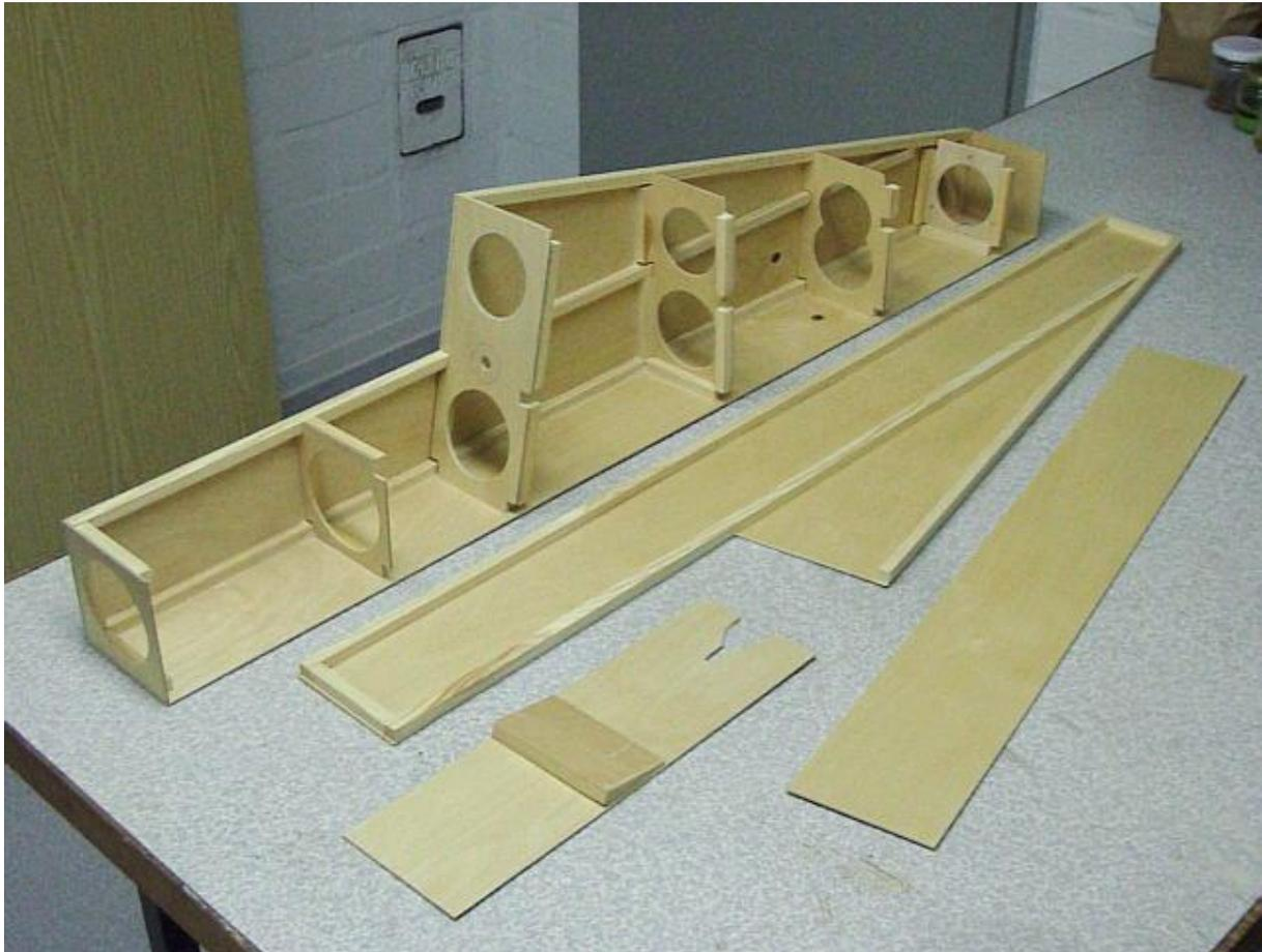
Auf dem Bild oben sind alle Holzteile des CSFR zu sehen. Die Spanten mit den Blenden sind bereits mit der einen Seitenwand verleimt. Noch fehlen die Linse und das Prisma sowie die Aluminiumteile, in denen diese montiert werden.
