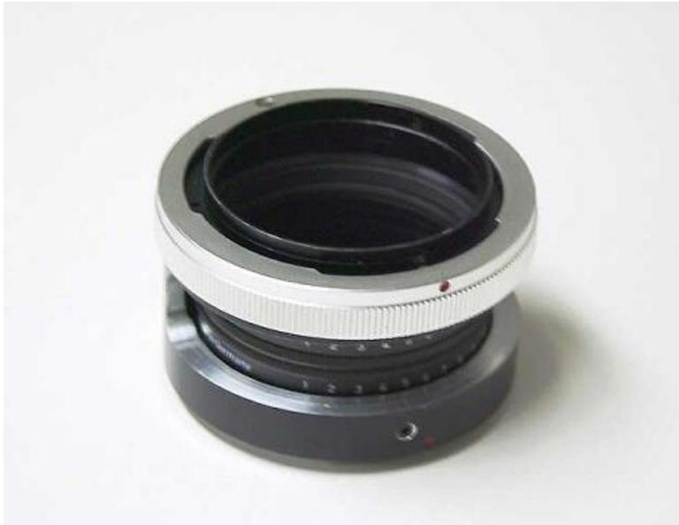
Die Fassung für die beiden vergüteten Polfilter wurde aus einem 25mm-Zwischenring des Canon FD-Systems gefräst. Für den Schmalbandfilter wurde ebenfalls eine Halterung angefertigt. Die beiden Polfilter sind über Winkelskalen gegeneinander verstellbar und dienen am CSFR der stufenlosen Helligkeitsregulierung. Sie sind aber an anderen Teleskopen auch für andere Zwecke einsetzbar. So hatten sie ihren ersten Einsatz bei Aufnahmen der Sonnenkorona bei der Sonnenfinsternis 2006.
