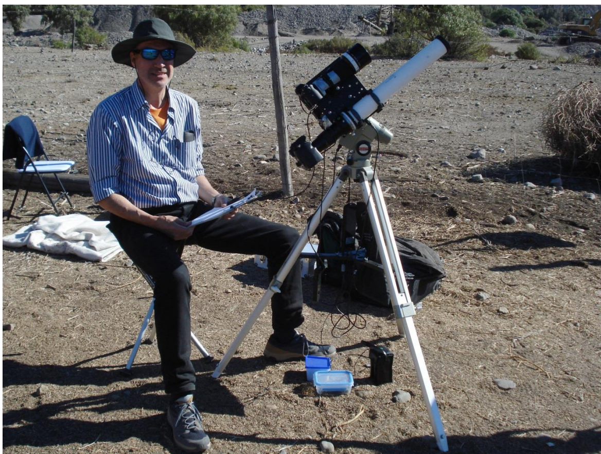
Bild 7: ZCR 50/540mm plus weitere Instrumentierung zur Beobachtung der totalen Sonnenfinsternis am 2.7.2019 auf Montierung Vixen GP; El Tambo am Puclaro-Stausee, Chile.
