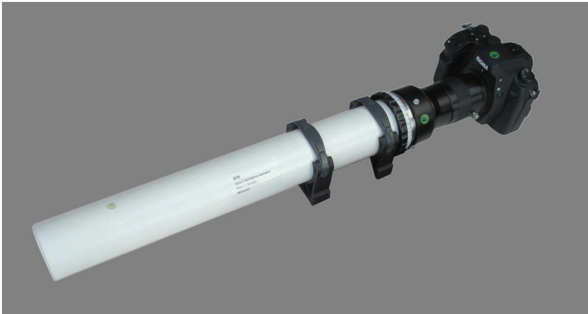
Bild 5: Der fertige ZCR mit montierter Kamera und 2x-Barlowlinse. Die Rohrschellen sind aus Kunststoff und stammen aus dem Aquarium-Bedarf.
