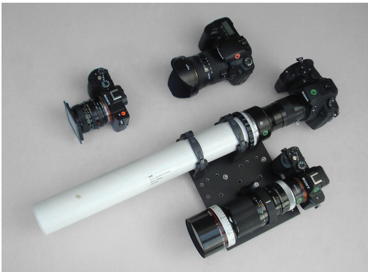
Bild 6: Die gesamte Instrumentierung für die Sonnenfinsternis am 2.7.2019 in Chile. Neben dem ZCR mit der Sigma SD1 Merrill fuhr noch eine Sony \alpha 7S mit einem Canon FD 4/300mm Teleobjektiv und Polfilter mit für Aufnahmen der Korona. Auf der Gegengewichtstange war eine weitere Sony \alpha 7S mit einem Weitwinkelobjektiv mit einem Blaze-Gitter für ein Flash-Spektrum abgebracht. (Dieses Experiment misslang leider.) Eine Zeitraffersequenz mit Weitwinkelaufnahmen wurde mit einer Canon EOS 20Da mit einem Sigma 3.5/10-20mm Zoom gemacht.
