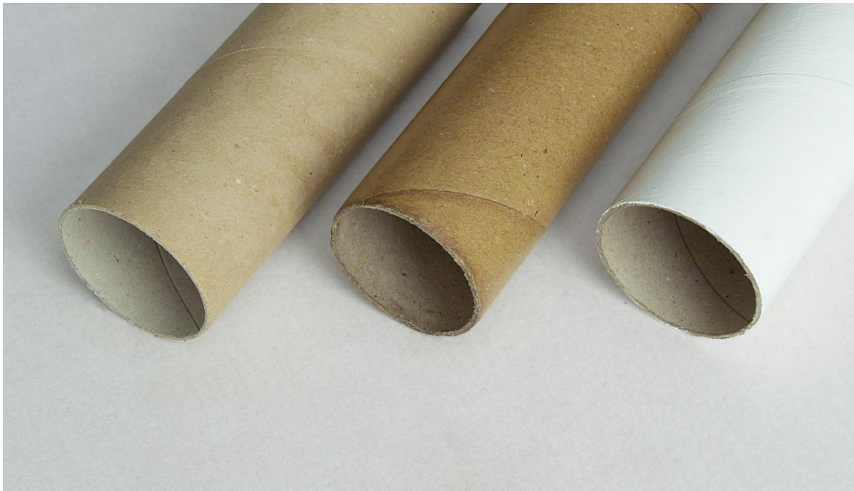
Bild 4: Der Papptubus. Durch Streichen mit Acrylfarbe gewinnt die Pappe enorm an Festigkeit.
