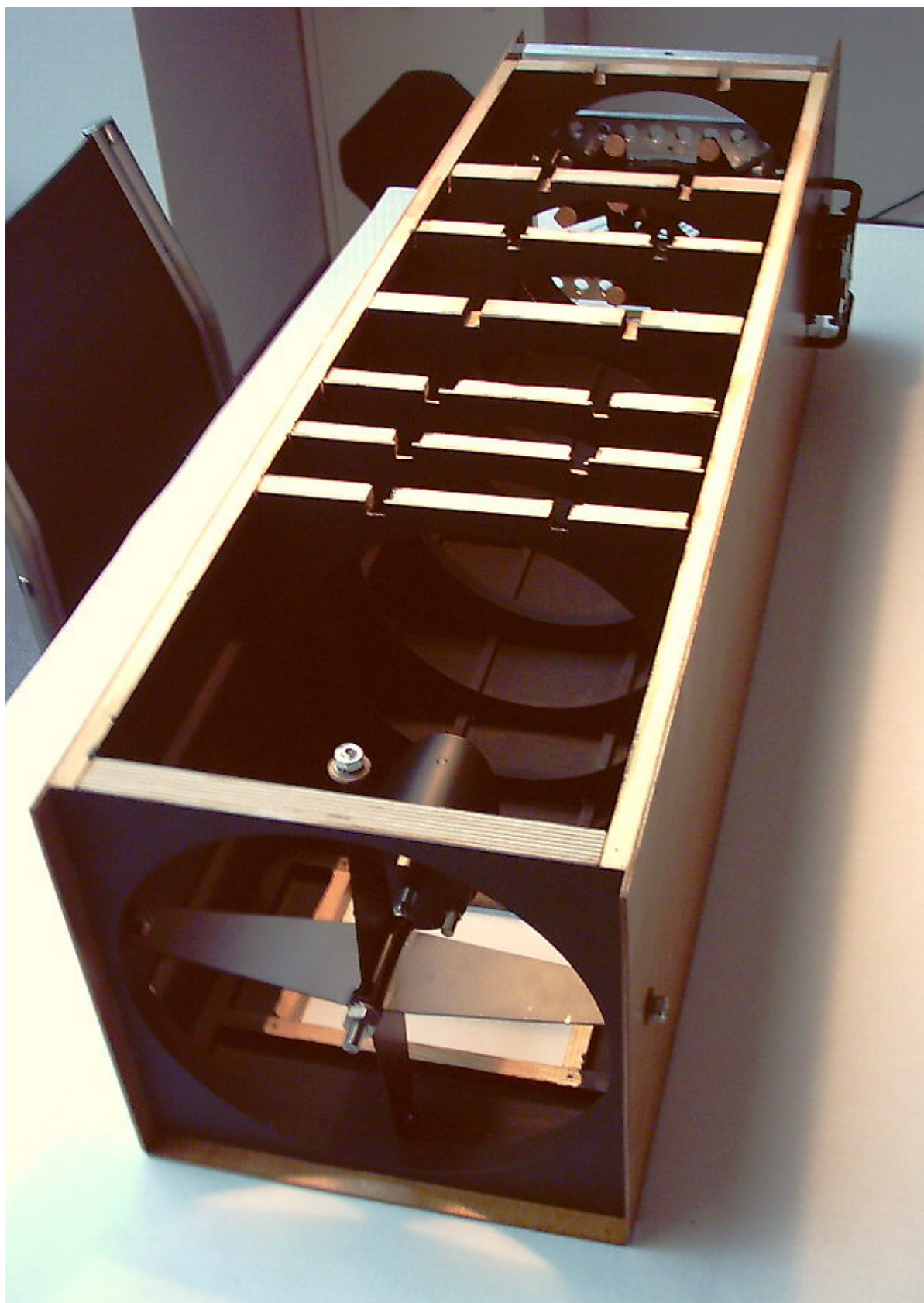
Von oben durch den noch offenen Tubus sind die insgesamt 8 Spanten mit den 7 Blenden zu erkennen
