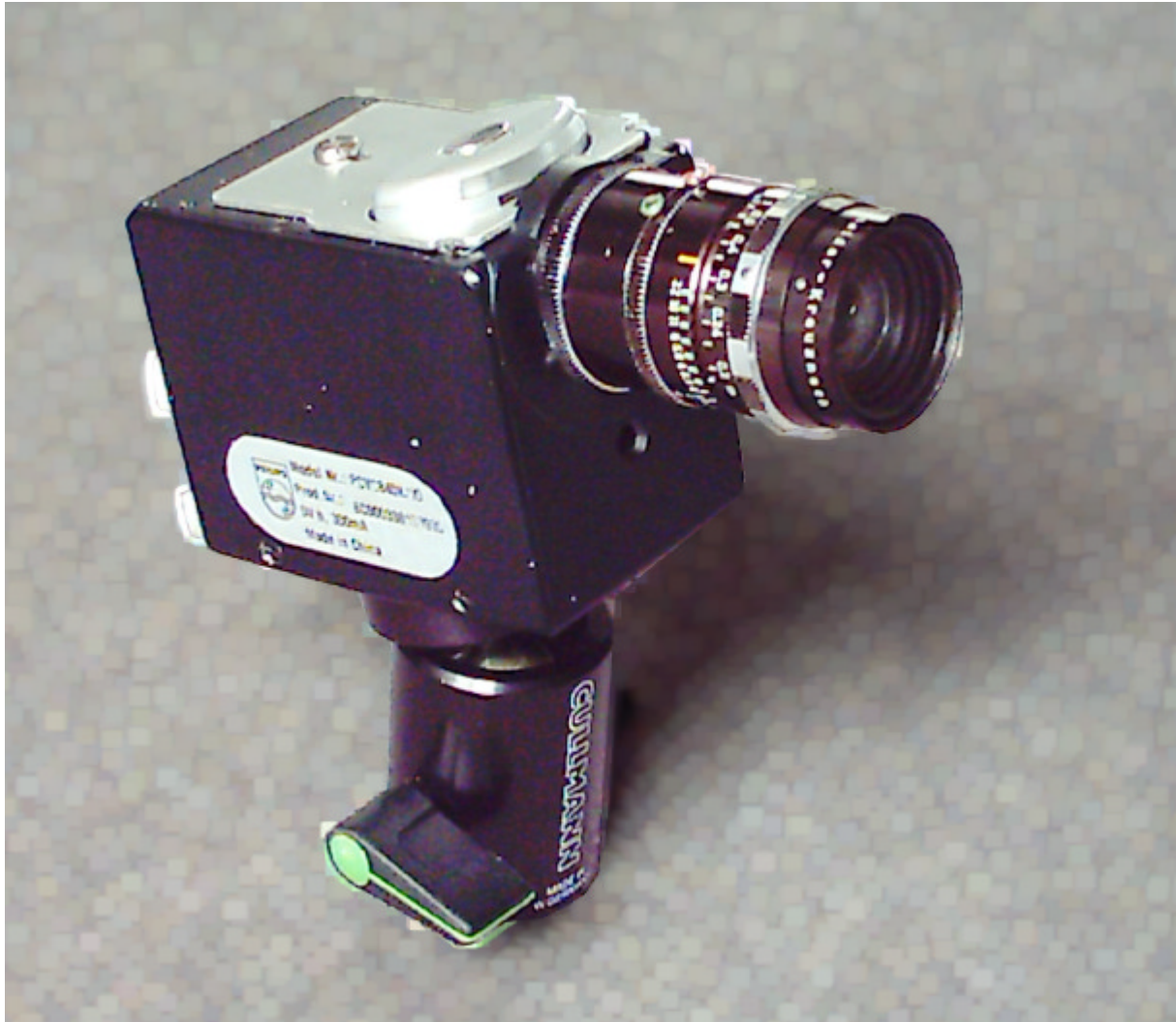
Bild 1: Modifizierte Phillips Toucam VC 840 K
