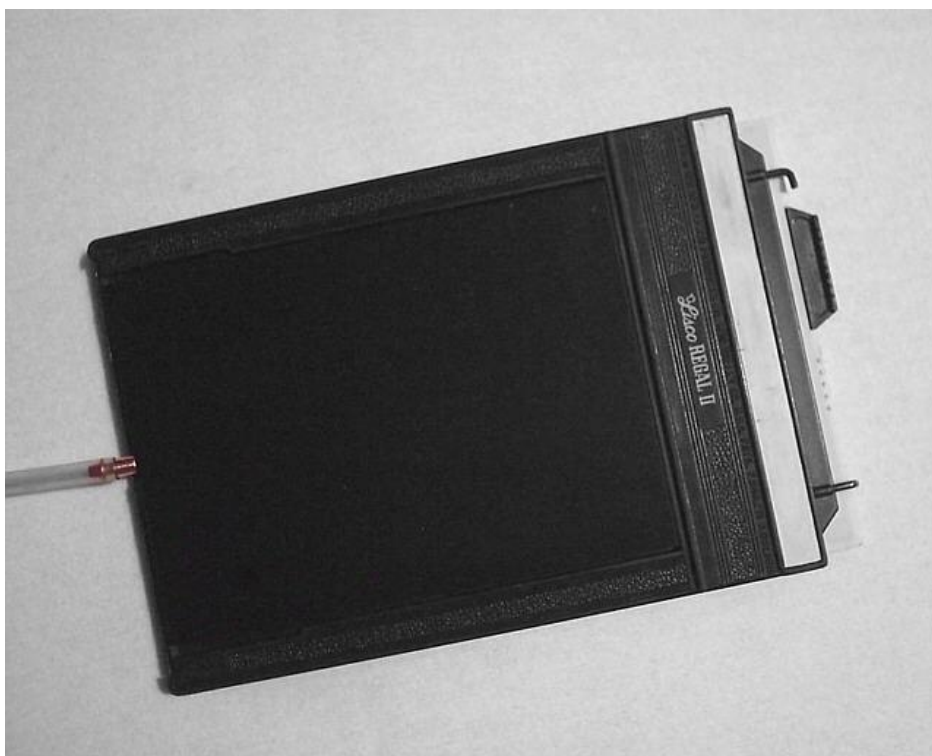
Die Ansaugkassette vor und nach dem Zusammenbau
