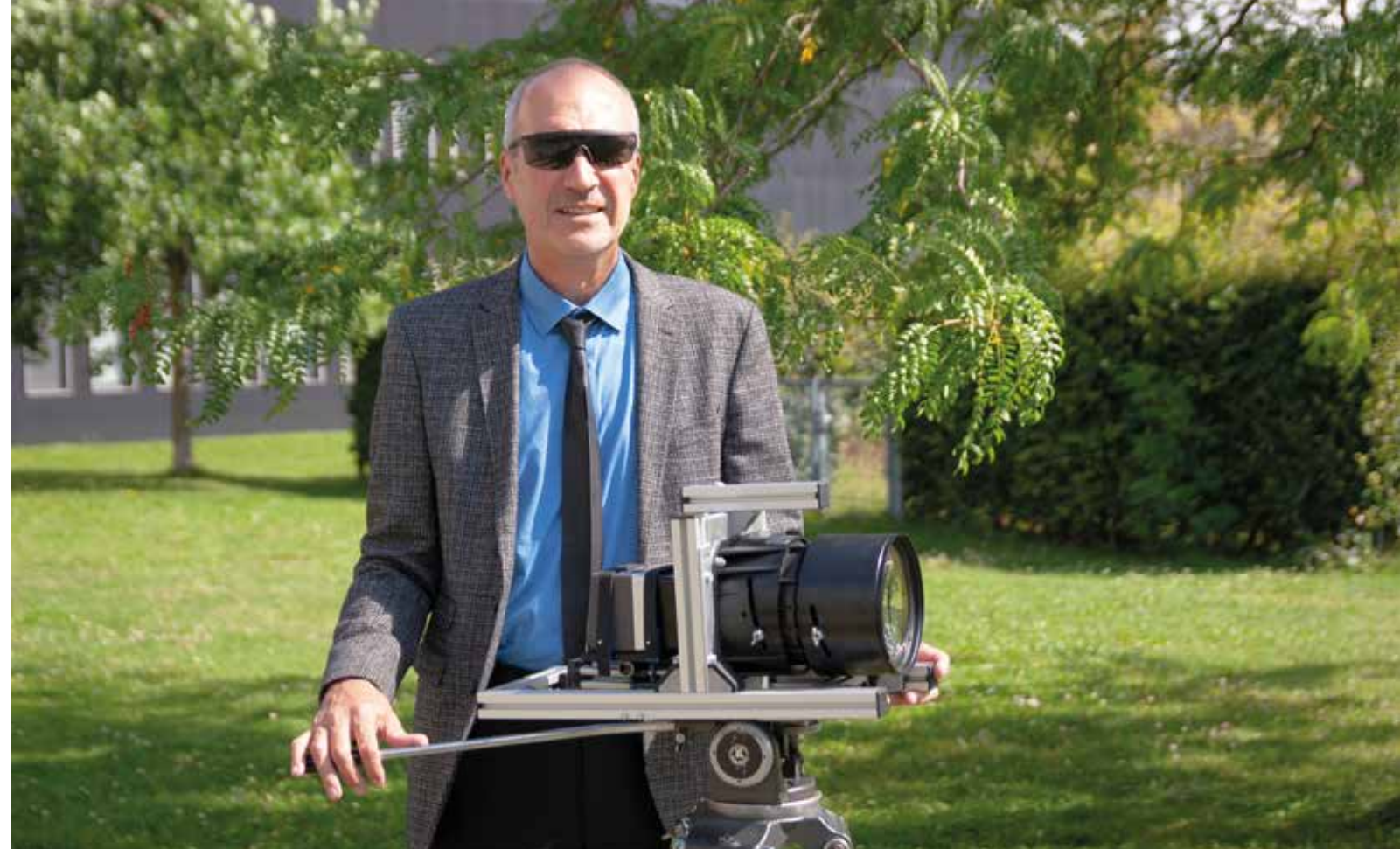
Experimenteller Kameraaufbau zur Simulation eines – physikalisch unmöglichen – Objektivs 0.33/46 mm (bezogen auf das 35 mm Format) für eine sehr geringe Tiefenschärfe.
