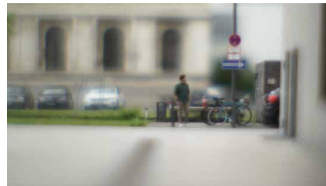
Filmstill aus dem Workshop Extremkinematografie 2024. Die Aufnahme erfolgte mit einer 1 m-Fresnellinse zur Simulation eines – physikalisch unmöglichen – Objektivs 0.044/49 mm (bezogen auf das 35 mm Format) für eine extrem geringere Tiefenschärfe.
